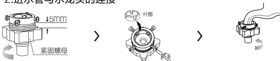
旋松紧固螺母，使螺纹露出约5毫米
