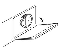
1. 拔掉电源插头，打开过滤器门
