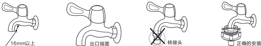
注：不要直接在洗衣机专用水龙头的转接头上安装连接座。如果用户已有洗衣机专用水龙头，为防止脱落漏水，请拧下转接头后，再按照下列图示方法连接进水管和水龙头。
