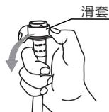
下压滑套，将进水管插入连接座
