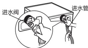
注：1.安装完毕后，打开水龙头，检查是否漏水。
