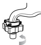
旋松紧固螺母，使螺纹露出约5毫米
