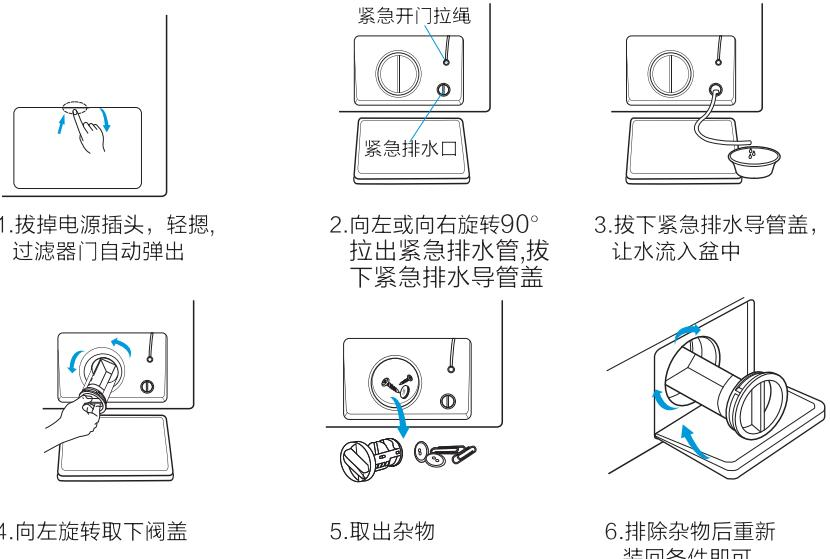
**注:装回阀盖和紧急排水管时,一定要安装到位, 阀盖筋需对准孔筋插入, 否则可能会出现漏水。**
