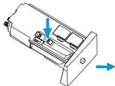
1.按[ OPEN ]键,洗涤剂盒自动缓慢弹出,按压A处卡扣,可将洗涤剂盒全部取出
