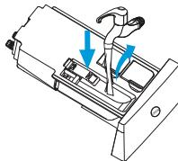
2.打开洗涤剂,柔顺剂盖,用水清洁所有凹槽
