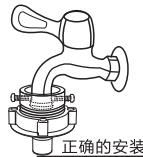
**注：不要直接在洗衣机专用水龙头的转接头上安装连接座。如果用户已有洗衣机专用水龙头,为防止脱落漏水,请拧下转接头后,再按照下列图示方法连接进水管和水龙头。**
