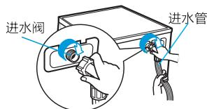
**注：1.安装完毕后，打开水龙头，检查是否漏水。
